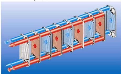
Рисунок 3.2. Одноходовая схема.
