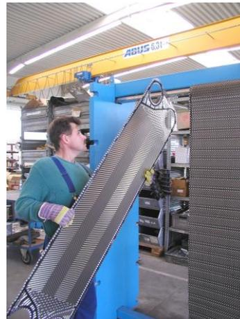
Рис 6.5. Демонтаж пластины с верхней направляющей.
