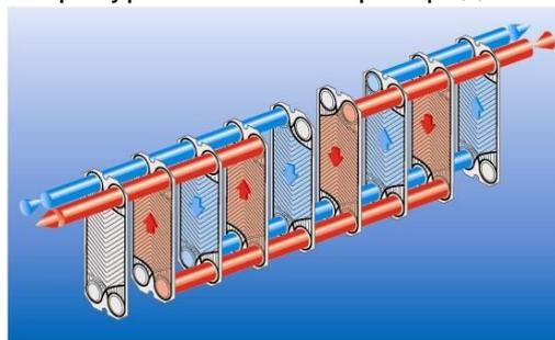
Рисунок 3.3. Многоходовая схема
