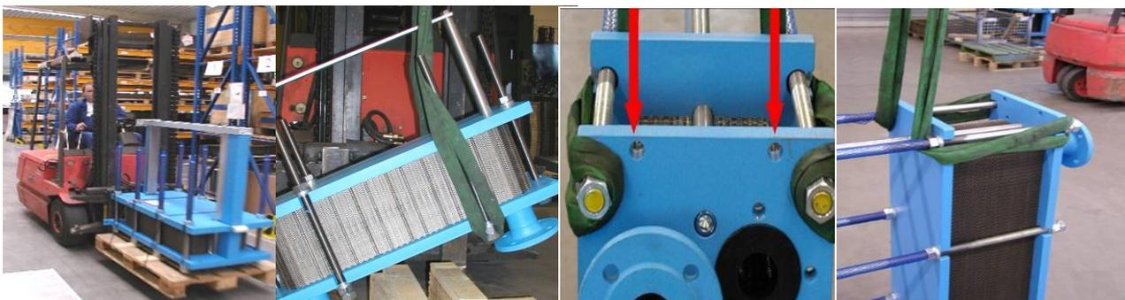
Рисунок 4.1. Транспортирование погрузчиком
