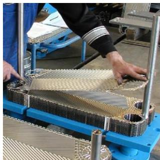
Рис 6.13. Сборка маленьких типоразмеров теплообменников
