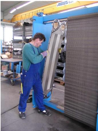
Рис 6.4. Демонтаж пластины с нижней направляющей.
