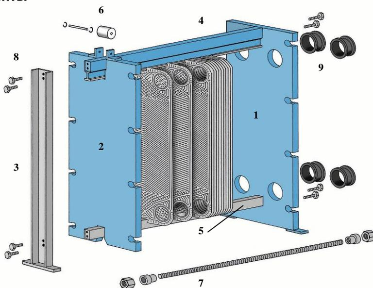
Рисунок 3.1. Конструкция теплообменника
