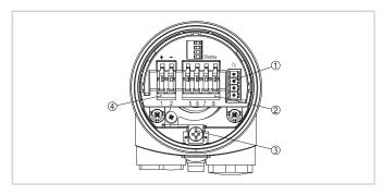
Отсек электроники и подключения (однокамерный корпус)
